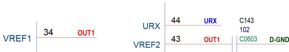
內部參考電壓從 VREF1 輸出後再從 VREF2 輸入，線圈訊號處理之參考電壓輸出後搭配穩壓電容 1Nf (102) 進行穩壓，該端點最大電壓為 3V，推薦使用 X7R 或 NP0 材質之電容，注意電容值為指定 102，搭配過大的電容會使訊號運作不穩定。
