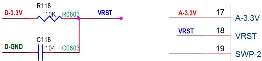
硬體重置接腳,通電後本腳需要輸入高電位 D-3.3V 後開始運作,為確認電路於上電完成後在開始運行所以配置上做 R-C 電路延遲啟動,於運作過程將此端點下拉到 GND 後進行重置.
